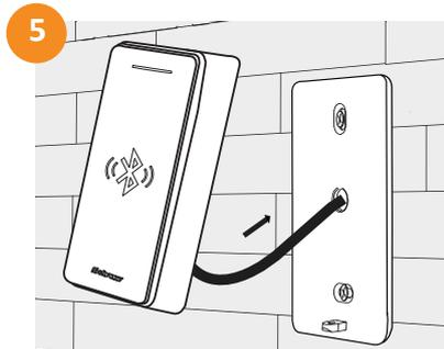
5 Pase los cables por el orificio de 10mm  $\Phi$  y conecte los cables.
