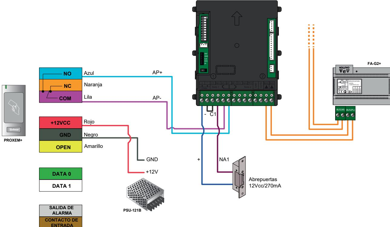
**NOTA:** El AP (apertura de puerta) del portero no activa el abrepuertas hasta que el pulso del lector ha finalizado. Para evitar demoras en la apertura, establezca el pulso mínimo de 1 segundo en el lector:
