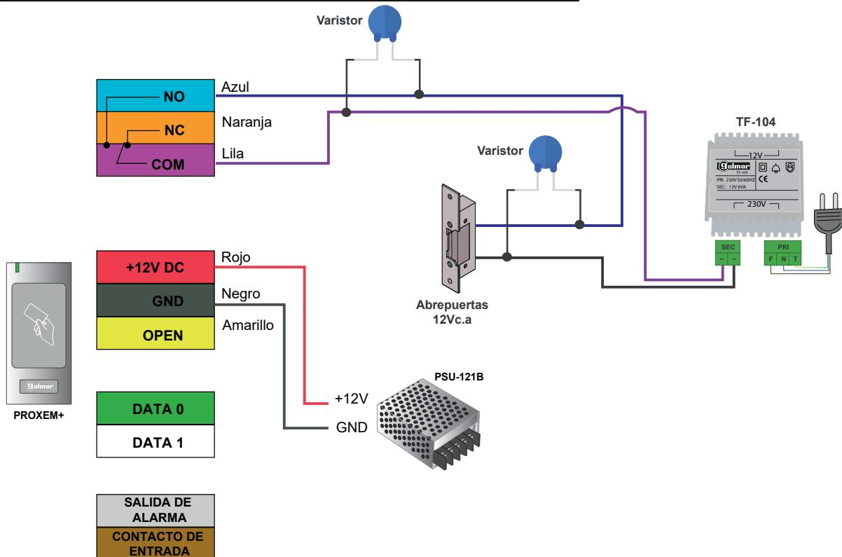
**IMPORTANTE:** Golmar recomienda utilizar abrepuertas de corriente continua, ya que la conexión de un abrepuertas de corriente alterna puede generar picos de tensión elevados que dañen el dispositivo o provoquen un funcionamiento inadecuado. En caso de hacerlo, proteja el equipo colocando un varistor en la salida del contacto del relé y otro en paralelo al abrepuertas.
