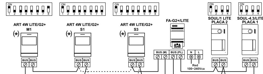
**4 monitores\_2 placas / 4 monitors\_2 door panels / 4 monitoren en 2 deurpanelen (B)**
