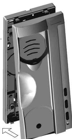
Pasar los cables por el orificio dispuesto a tal efecto, y conectarlos a la regleta según los esquemas de instalación. Cerrar el teléfono tal y como muestra el dibujo. Una vez cerrado, conectar el auricular mediante el cordón telefónico y colocarlo en la posición de colgado.
