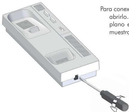
Para conectar el teléfono y fijarlo a la pared, es necesario abrirlo. Realizar levemente palanca con un destornillador plano en las ranuras dispuestas para ello, tal y como muestra el dibujo.
