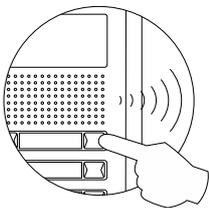
Realizar una llamada para comprobar que el monitor se ha programado con éxito. Programar el resto de monitores de la misma forma. Finalizada la programación coloque el interruptor de programación en la posición OFF. Caso de olvidarse, la placa emitirá tonos que le advertirán que no salió del modo de programación.
