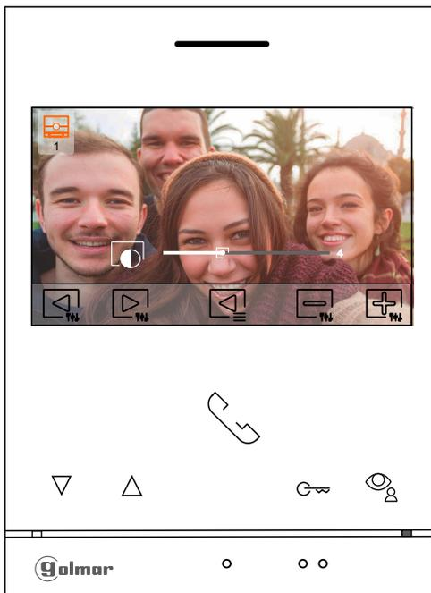
A continuación se mostrará el siguiente menú de ajuste del color, modifique al nivel deseado presionando los pulsadores situados debajo de los iconos / . Para acceder al ajuste del volumen de llamada/ comunicación en el monitor presione el pulsador situado debajo del icono . Para salir del menú de ajustes imagen y comunicación presione el pulsador situado debajo del icono .
