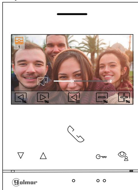
Para salir del menú de ajustes imagen y comunicación presione el pulsador situado debajo del icono .
