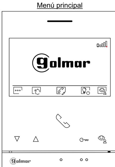
Si el equipo se encuentra en reposo (pantalla apagada), para acceder al menú principal presione en cualquiera de los pulsadores del monitor. A continuación presione sobre el pulsador situado justo debajo del icono correspondiente. El equipo volverá al estado de reposo transcurrido 20 segundos sin actividad.
