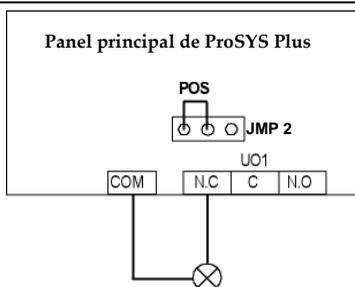
**Negativo (NEG):** Cuando el puente JMP 2 se coloca en NEG, el terminal C de UO1 recibe COM.
