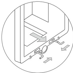
Inserte el muelle bisagra que se adjunta con el producto en la caja de empotrar, tal y como muestra el dibujo.
