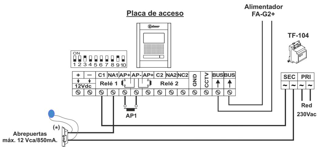
(\*) **Importante:** Coloque el varistor suministrado con el módulo de video directamente sobre los terminales del abrepuertas.
