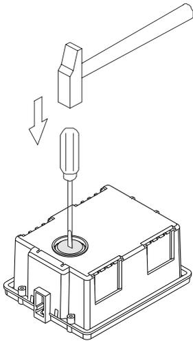
Romper el tabique para la entrada de cables por la parte inferior de la caja.
