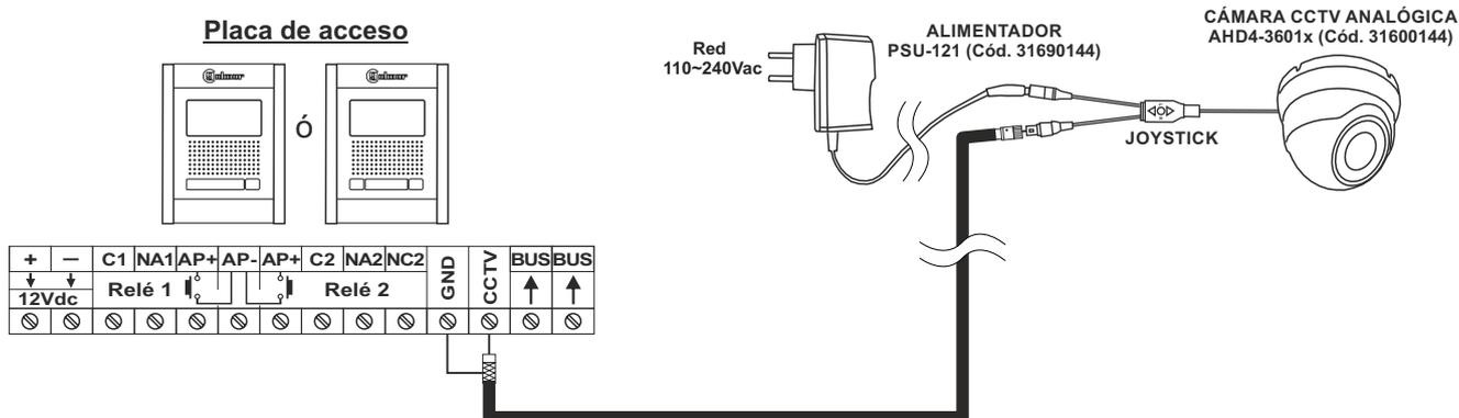
**Importante:** Configure la cámara con señal analógica CVBS, tal como se describe en el manual adjunto de la cámara "AHD4-3601x".
