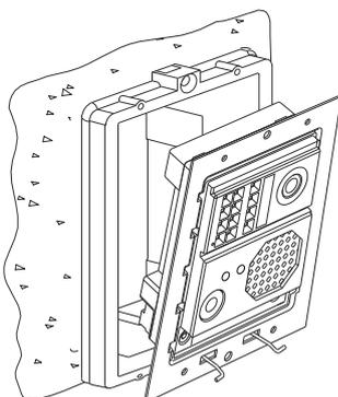
El bastidor puede ahora abatirse horizontalmente facilitando de esta manera realizar tanto el conexionado como ajustes en el módulo de video.
