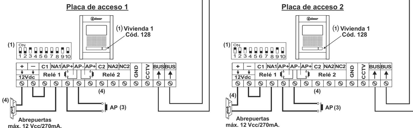
(1) Configure los microinterruptores de las placas tal como se muestra en el esquema de instalación para videoportero con 2 placas de acceso. Ver nota(1.1) "IMPORTANTE".
