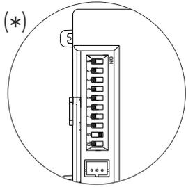
El microinterruptor de configuración está ubicado en el lateral superior izquierdo de la parte posterior del módulo de video.
