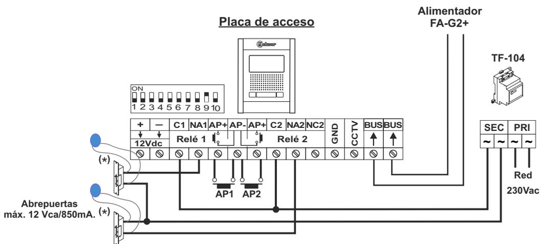
(\*) **Importante:** Coloque los varistores suministrados con el módulo de video directamente sobre los terminales de los abrepuertas.
