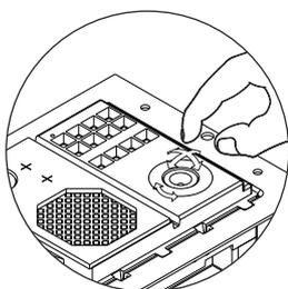
La telecámara dispone de un mecanismo de orientación horizontal y vertical. Si la orientación no fuese la correcta, corrija su posición.
