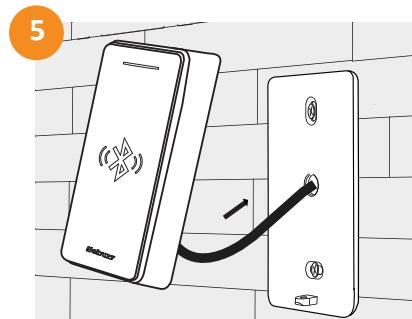
Pase los cables por el orificio de 10mm  $\Phi$  y conecte los cables.
