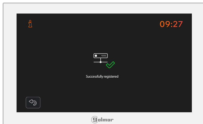
Monitor registrado correctamente en el servidor SIP
