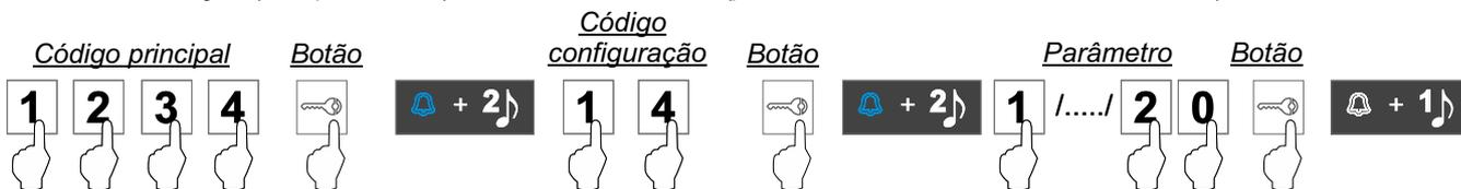
**Função 8. Volume altifalante placa:** A seguinte sequência de programação permite ajustar o volume do altifalante na placa (3 “por defeito”) do mínimo ao máximo (parâmetros: de (1 a 5) 1: mínimo /...../ 5: máximo).
