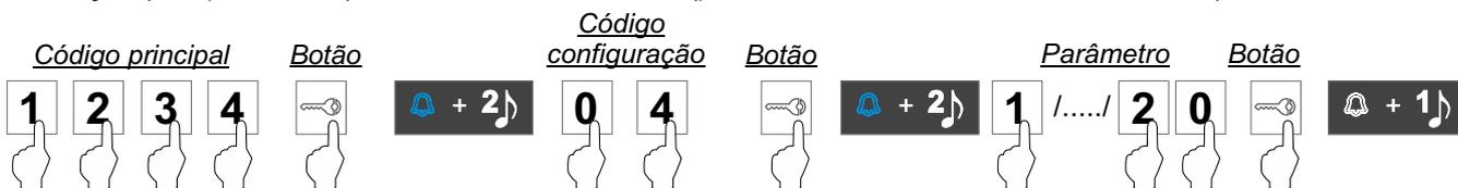
**Função 6. botão exterior “AP” de ativação remota:** A seguinte sequência de programação permite selecionar que saída ativa o botão exterior “AP” (parâmetros: 0: trinco elétrico “por defeito” / 1: relé auxiliar / 2: ambos).
