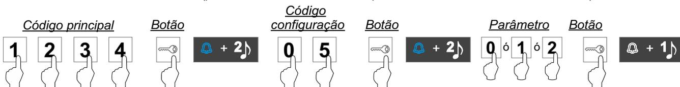
**Função 7. botão exterior “AP” atraso da ativação remota:** A seguinte sequência de programação permite ajustar o tempo de atraso ativação (2 s “por defeito”) do botão exterior “AP” (parâmetros: 1: 0,5 s / 2: 1 s /...../ 20: 10 s).
