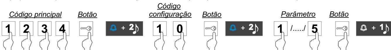
**Função 9. Endereço da placa:** A seguinte sequência de programação permite atribuir um endereço à placa (parâmetros: de (1 a 4) 1: endereço 1 “por defeito” / 2: endereço 2 / 3: endereço 3 / 4: endereço 4).
