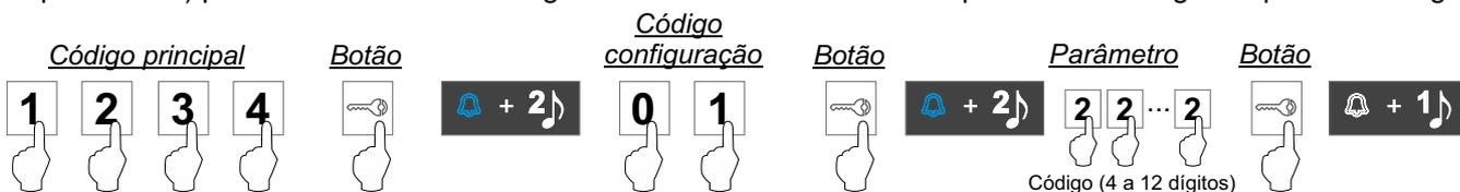
**Função 3, Leds botões teclado iluminados de noite:** A seguinte sequência de programação permite que o teclado esteja ou não iluminado durante a noite (parâmetros: 0: iluminado “por defeito” / 1: apagado).
