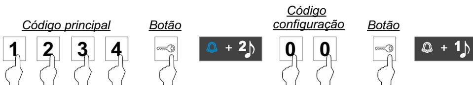
**Função 2, Alterar código principal:** A seguinte sequência de programação permite alterar o código principal (1234 “por defeito”) por outro diferente do configurado de fábrica e com um comprimento do código de quatro a 12 dígitos.
