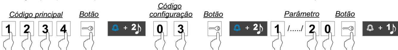
**Função 5. Tempo ativação saída trinco elétrico:** A seguinte sequência de programação permite ajustar o tempo de ativação (3 s “por defeito”) da saída do trinco elétrico (parâmetros: 1: 0,5 s / 2: 1 s /...../ 20: 10 s).
