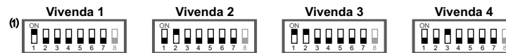
(t) Vivenda 1 (Dip1 a ON) monitor ART 7W/G2+ com V04 e posterior.
