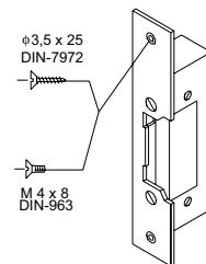
**IMPORTANTE:** El abrepuertas debe ser de 12V corriente continua o alterna Golmar. (\*) Con abrepuertas de alterna (necesario alimentador TF-104) y coloque varistor suministrado con el módulo telecámara directamente sobre los terminales del abrepuertas.
