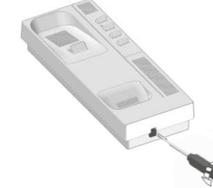
Abrir el teléfono, realizando levemente palanca con un destornillador plano en las ranuras dispuestas para ello, como muestra el dibujo.
