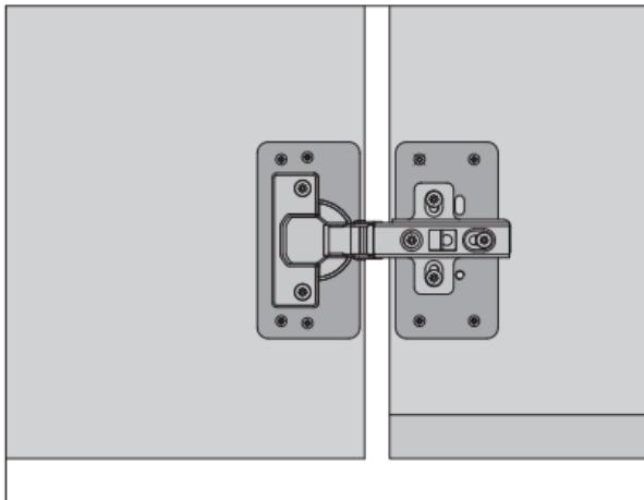
Fácil instalación: Retirar los tornillos de la bisagra, colocar la placa en su posición y atornillar la placa en el lugar donde tiene que ir la bisagra.
