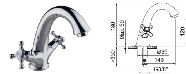
Lavabo bimando con aireador y flexibles 3/8" >350mm. Two-handed basin mixer with aerator and flexible hoses 3/8" >350mm. Mélangeur lavabo avec aérateur et flexibles de raccordement 3/8" >350mm.
