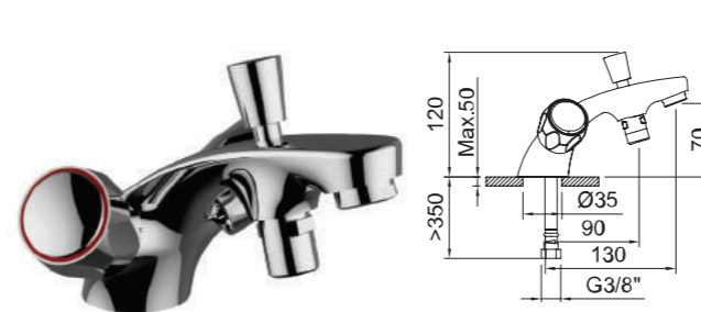
Baño-ducha bimando monotrou con aireador, inversor automático y flexibles 3/8" >350mm. Two-handed bath-shower mixer monotrou with aerator, automatic diverter and flexible hoses 3/8" >350mm. Mélangeur bain-douche monotrou avec aérateur, inverseur automatique et flexibles de raccordement 3/8" >350mm.
