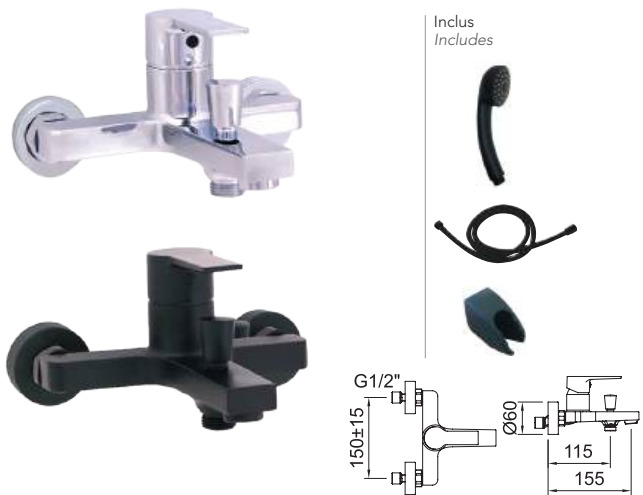
Mitigeur bain-douche avec aérateur et inverseur. Single-lever bath-shower mixer with aerator and diverter.
