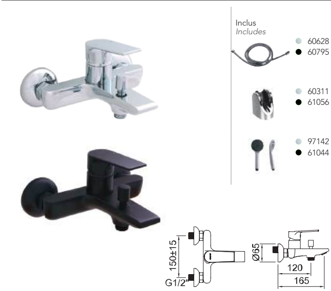
Mitigeur bain-douche avec aérateur et inverseur automatique. Single-lever bath-shower mixer with aerator and automatic diverter.
