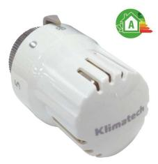
El cabezal termostático W6 permite un ajuste individual de la temperatura ambiente. Son reguladores proporcionales permanentes. Estos cabezales reaccionan automáticamente a variaciones de temperatura de la habitación. Si aumenta la temperatura ambiente, por ejemplo por efecto de los rayos solares, el sensor líquido limita la circulación del agua en el radiador, reduciendo el paso por la válvula.
