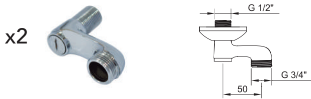
Raccordo eccentrico universale da 3/4"x1/2" (2 unità). Eccentric nut 3/4"x1/2" (2 units).
