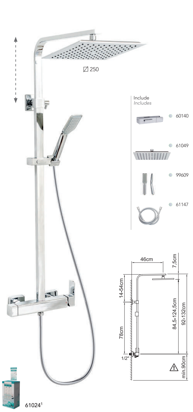
Kit doccia con monocomando con asta estraibile con supporto articolato scorrevole. Single-lever shower set mixer with extendable bar with sliding articulated support.
