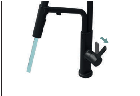
Saída de água misturada Mixed water outlet
