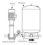
Schéma 1.4-6 Pompe de surpresion avec Réservoir
