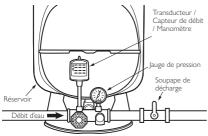
Schéma 1.4-1 Installation du réservoir avec accessoires
