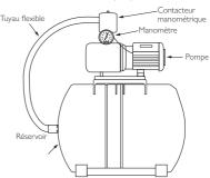
Schéma 1.4-4 Pompe de gavage w/ Réservoir horizontal
