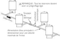
Schéma 1.5 Installation a réservoirs multiples
