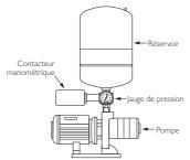
Schéma 1.4-5 Pompe de surpresion avec Réservoir en ligne
