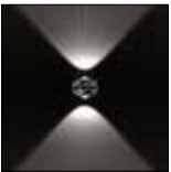
Effet lumineux avec lentille de 80°
