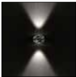
Effet lumineux avec lentille de 50°
