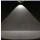
Effet lumineux avec lentille de 80°
