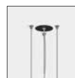
Innere parallele Seilabhängung
