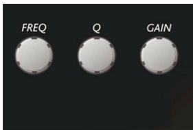
**[8]-Botones rotatorios:** Estos botones comandan codificadores de triple velocidad que permiten el ajuste de los parámetros relevantes, cuando se visualizan en la pantalla.
