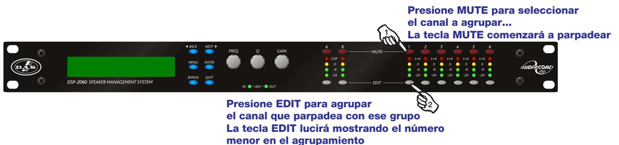
Presione la tecla MUTE del canal escogido para agrupar (la tecla tiene un Led interior que comenzará a parpadear), y una tecla EDIT se iluminará para indicar que salida está agrupada con él actualmente. Para cambiar esta selección, basta con presionar una tecla EDIT distinta, cambiando los miembros de los grupos de trabajo desde el número superior al inferior. Por tanto, para agrupar las salidas 1 y 5, presione MUTE 5 y entonces EDIT 1. En la pantalla aparecerá:
