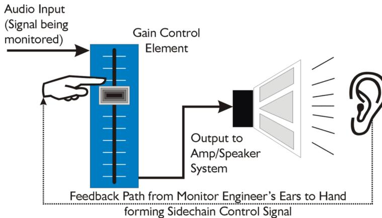
Hay una cadena lateral ('sidechain') oculta actuando en este caso. El ruta principal de la señal es alimentada por la mesa de supervisión y la ganancia controlada por el ajuste del 'fader'. La cadena lateral está formada por el camino de realimentación por los oídos del ingeniero que supervisa y su cerebro dando instrucciones a su mano para bajar el 'fader' si el volumen es superior al umbral elegido.
