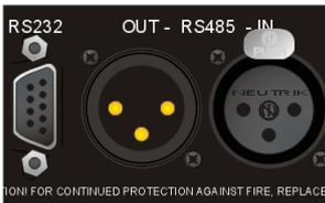
**[2]-RS232:** Conector estándar RS232 tipo D de 9 pines para conexión a PC. Los datos son convertidos a RS485 y reenviados a las unidades esclavo mediante los conectores de salida RS485.
