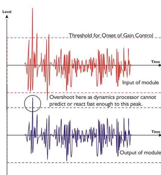
Para un procesador dinámico analógico, la situación es mucho mejor. Controlando la ganancia electrónicamente, y no dependiendo de un mecanismo de retroalimentación humano de cadena lateral, se puede reaccionar más rápidamente.
