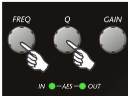
Y girando el botón FREQ conseguiremos variar el valor de la frecuencia y girando el botón Q la pendiente. Para conservar el valor seleccionado pulse ENTER. Después de presionar la tecla EDIT del canal de salida que deseemos editar, pulsando las teclas BACK o NEXT podemos ir pasando de unos parámetros a otros, siendo visualizados en pantalla.
