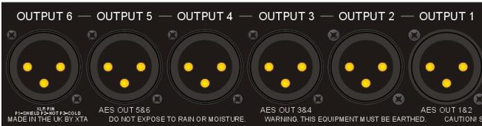
**[4]-Salidas de audio:** Cada canal está provisto de un conector para la salida de señal del tipo XLR de tres pines, con señal balanceada:
