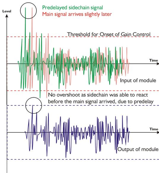
El limitador “D-Max” del *DSP-2060A*, retrasa previamente la señal de cadena lateral, resultando un limitador sin rebasamientos, por el cual es posible atrapar todos los picos y proveer de una fiabilidad máxima a la configuración de salida de cualquier canal.
