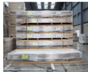
Apilamos un máximo de 6 alturas, lo que equivale a 12 cajones por contenedor que equivale a una superficie de 898.56m² de lámina cerámica con un peso neto de 12.580 kg
