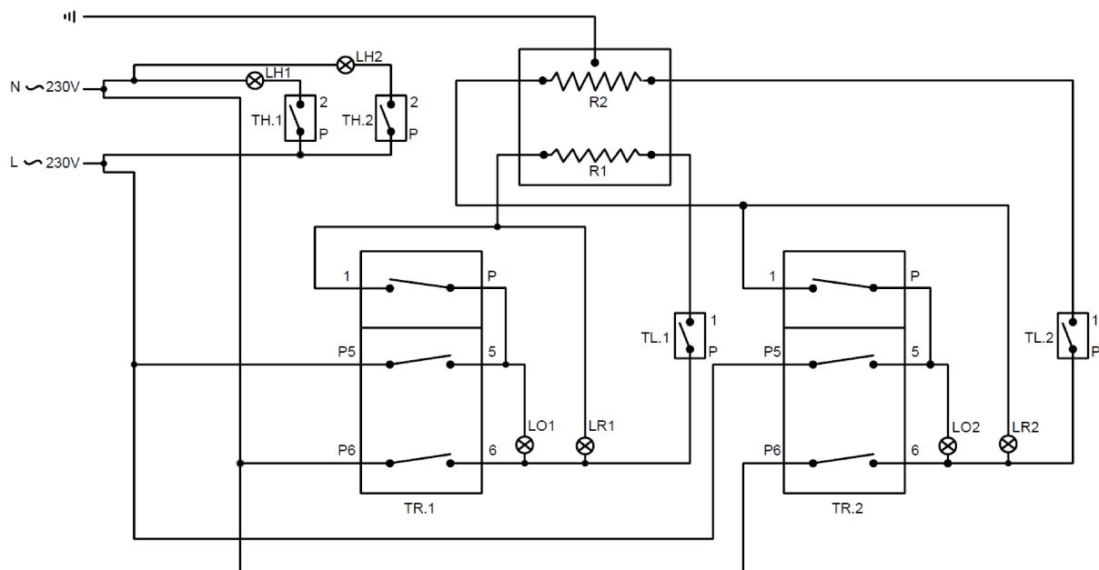
TR.1 : Termostato di controllo (50-250°C) per la zona anteriore
