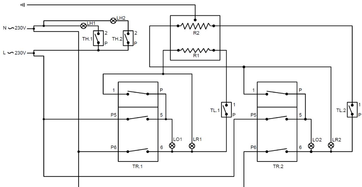
TR.1 : Thermostat de commande (50-250°C) pour la zone avant
