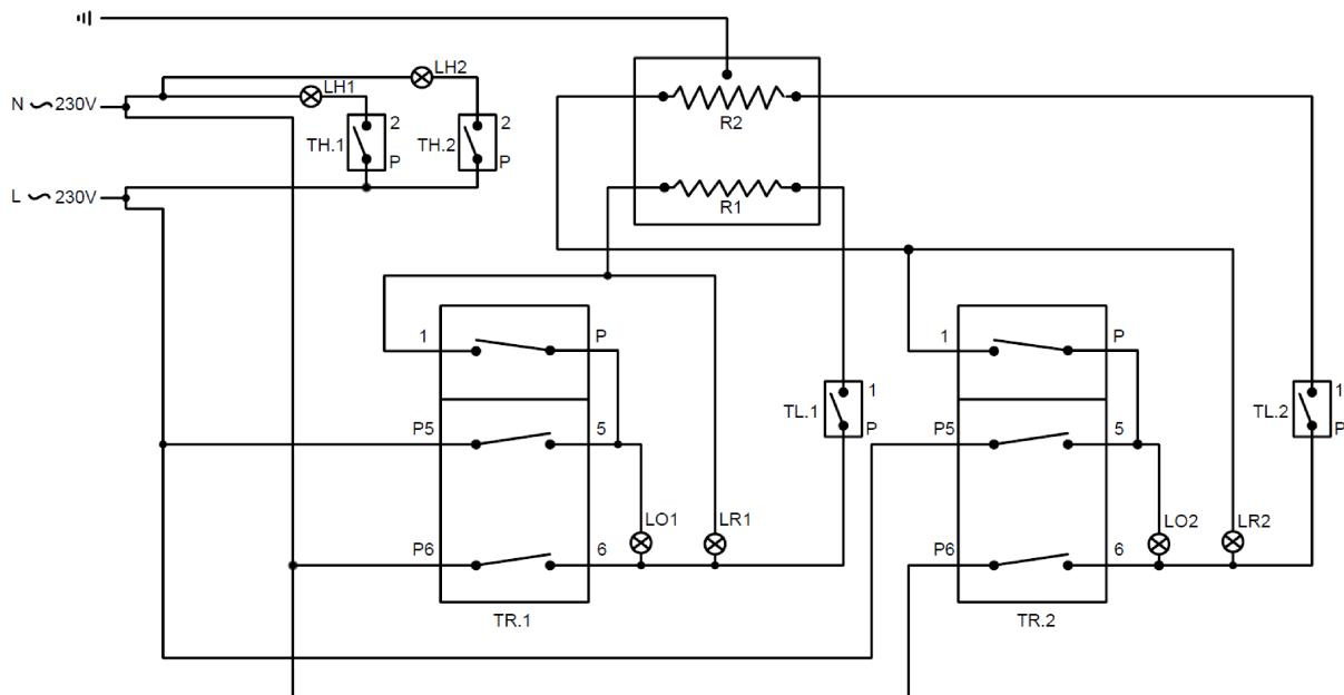
TR.1 : Termostato de mando ( $50-250^{\circ}\text{C}$ ) por la zona delantera
